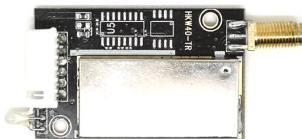
HKW40-TR 模块是高度集成半双工大功率无线数据传输模块，其嵌入高速单片机和高性能射频芯片。HKW40-TR 模块提供了多个频道的选择，可在线修改串口速率，发射功率，射频速率，发射信道等各种参数。HKW40-TR 模块能够透明传输用户数据，而用户无须编写复杂的设置与传输程序，模块提供宽电压输入 3.6-7.5V，有比较远的传输距离，适合环境恶劣而且有传输比较远的要求的需要。
